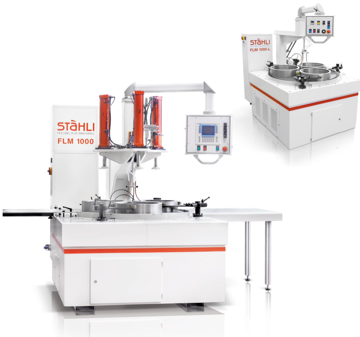
Les machines de la gamme FLM 750 à FLM1500 peuvent être équipées pour le Rodage et le Polissage Plan, d'un plateau pour grains libres, pour le Honage Plan d'un plateau vitrifié (diamant/CBN), et pour la Micro-Rectification, d'un plateau à revêtement SiC. L'utilisation de cette gamme dans les petites, moyennes ou grandes entreprises est multiple et est
