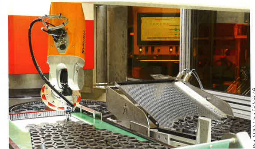
Mit Kameras erkennt der Roboter die Position und die Lage der Werkstücke, um sie orientiert in die Läuferscheiben einzulegen.
