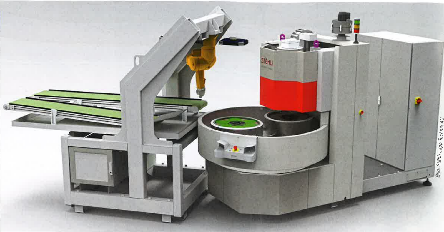
Innovatives Maschinenkonzept einer Flachhonsmaschine mit drei Scheiben und Roboter zum hauptzeitparallelen Be- und Entladen.
